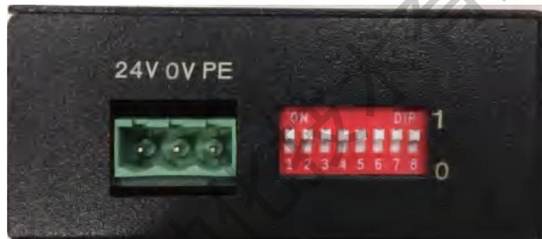
图 3.2 电源端口图
