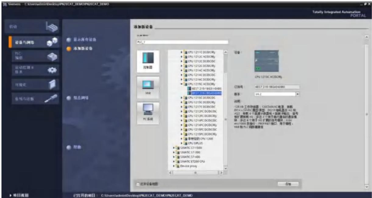
在视图中，选择“设备和网络”并单击“添加新设备”（或者在项目视图中的项目名称下，双击“添加新设备”），如下图“添加新设备”对话框，添加支持 PROFINET 接口的控制器，例如 6ES7 25-1BG40-0XB0。
