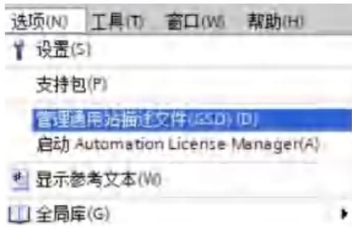
在弹出的对话框中，选择“已安装的 GSD”选项卡，点击源路径选择按钮，弹出浏览文件夹对话框中找到选择 GSD 文件“GSDML-V2.33-JY-EnTalk-20210807”所在的文件夹路径并选中，点击确认即可。
