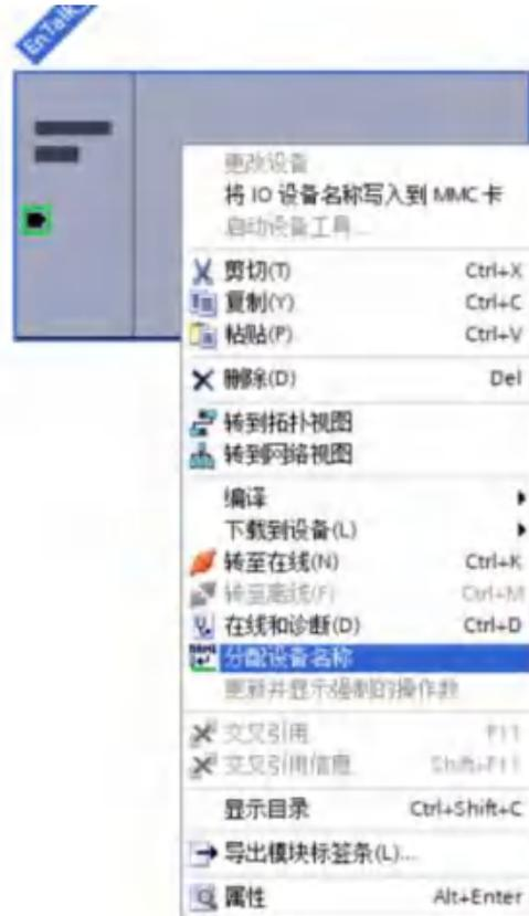
弹出“分配 PROFINET 设备名称”对话框，在“网络中的可访问节点”下点击更新列表（EnTalk 王干设备正确连接在网络里）即可访问出 PROFINET 网络里的各个节点；选中更新列表的节点，点击“分配名称”将组态的 PROFINET 设备名称：pn2ecat 写入网络节点中；写入成功后 PROFINET 设备名称更新为“pn2ecat”，状态为“正确”；关闭该对话框；重启网关后设备名称有效。
